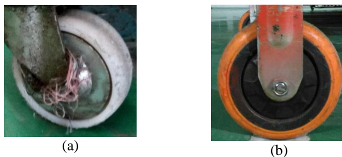
Gambar 6. Kondisi roda troli (a) Sebelum perbaikan; (b) Setelah perbaikan
