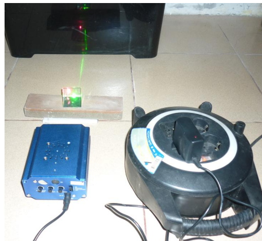
Gambar 7. Rangkaian menentukan indeks bias prisma menggunakan laser hijau
